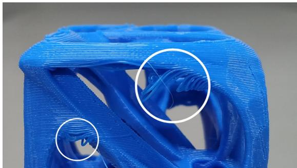
Figura 2. Exemplo de impressão na qual houve o decaimento do filamento, já com a aplicação do *plug-in*.
