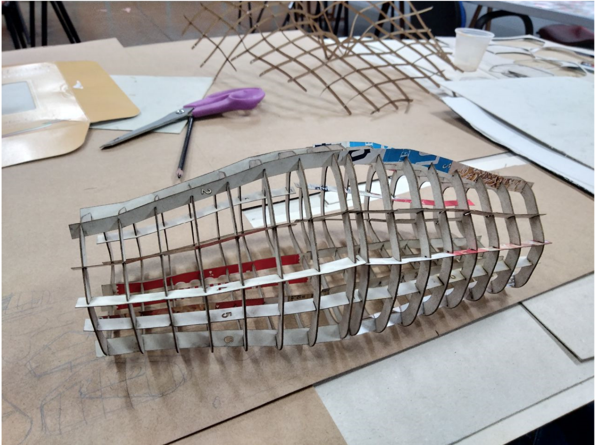
Figura 4 – Segundo protótipo montado utilizando caixas de alimento recicladas
