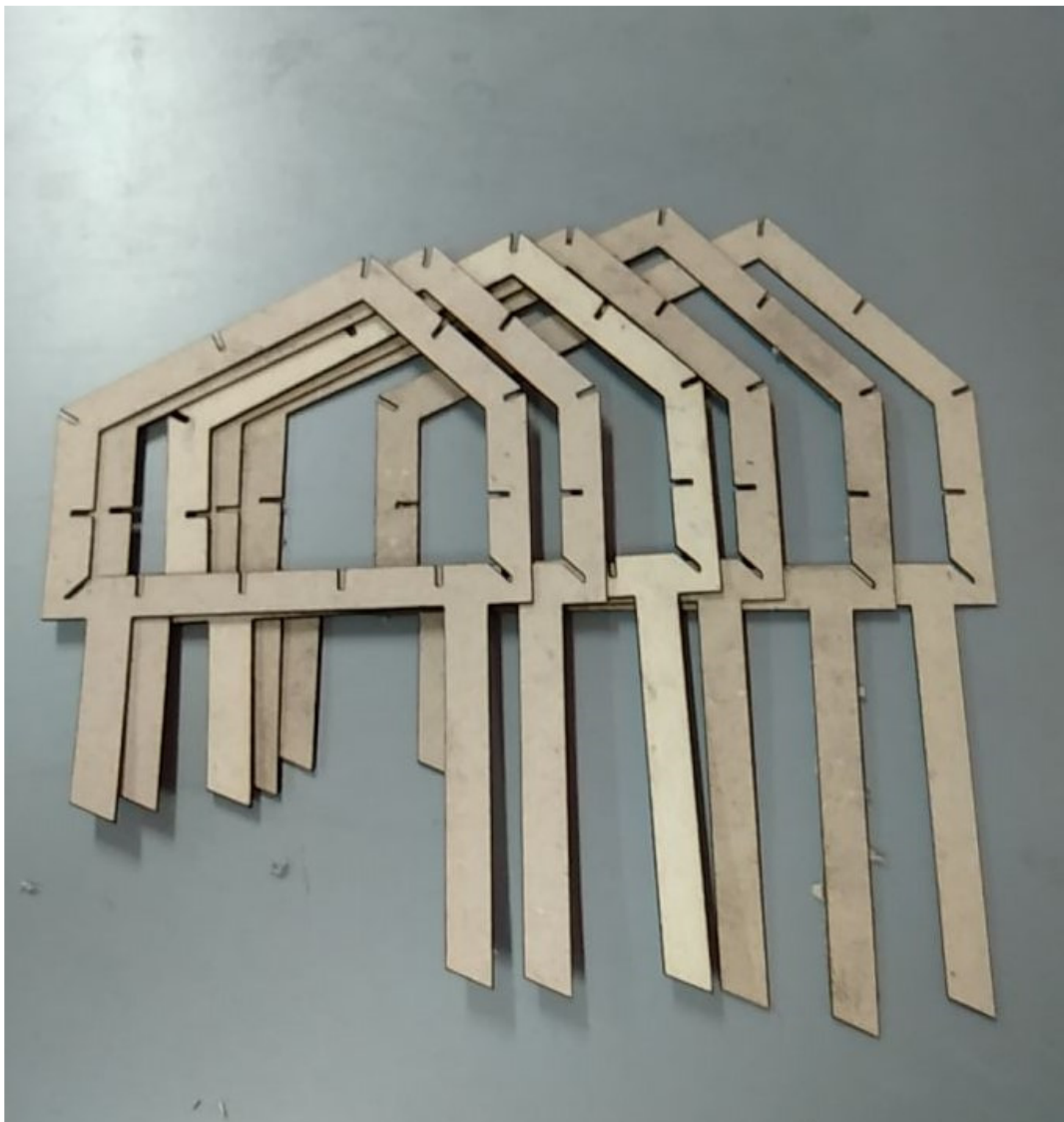
Figura 2 – Primeiros pórticos cortados a laser utilizando papel paraná
