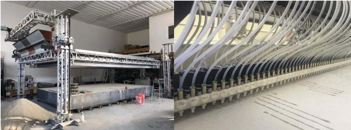
Figura 09. Impressora 3D D-Shape (esquerda) e cabeças de impressão (direita) Fonte: Lowke, Dini. et al. (2018)
