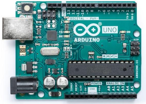
Figura 1. Placa Arduino UNO. Fonte: Aduino.
