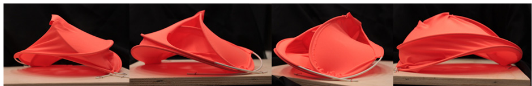
Fig. 33 – Variações no arranjo formal do protótipo do mobile , executadas com tecido flexível cortado a laser e varas flexíveis de PVC, fixado em base de madeira, 2011. Fonte: Acervo do autor.
