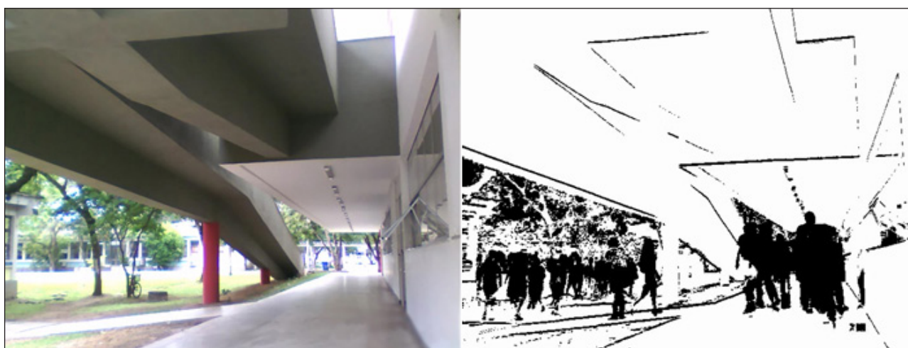
Fig. 78 - À direita foto do ângulo visual a ser analisado e à esquerda o resultado do processamento digital por diferenciação de frames realizado no software Processing , Grupo de Estudos Experimentais Conexão vix, 2013. Fonte: Acervo Grupo de Estudos de Software Conexão vix/UFES.
