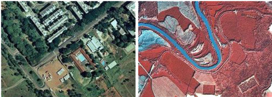
FIGURA 8 - Ortofotos tiradas a partir de sobrevôos. Exemplos de ortofoto em infravermelho e ortofoto colorida 166 . Fonte: < www.esteio.com.br/produtos/paginas/Prod-Orto.htm >.
